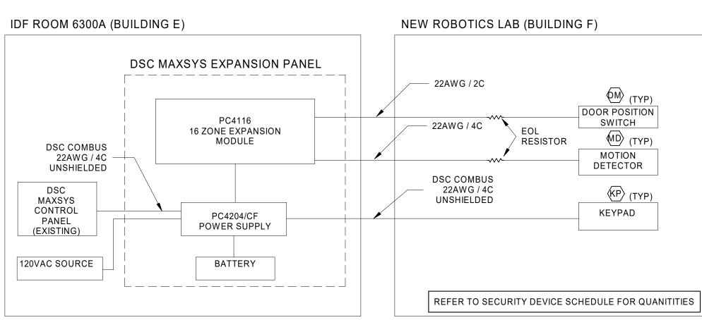
2 RISER DIAGRAM INTRUSION DETECTION ZONE EXPANSION PANEL NTS
